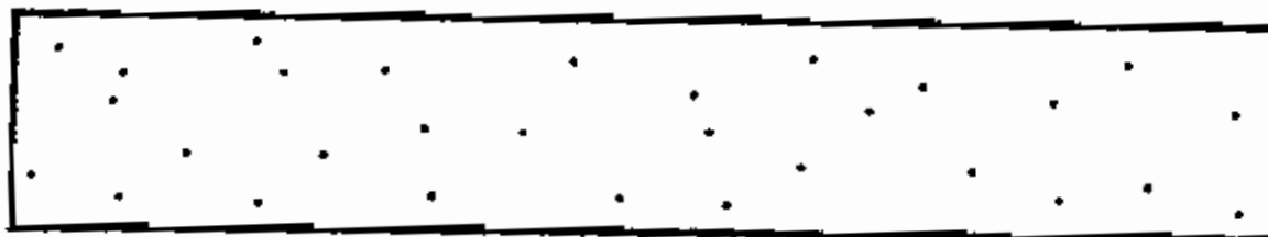
(D) SMALL ROUNDED INDICATIONS
